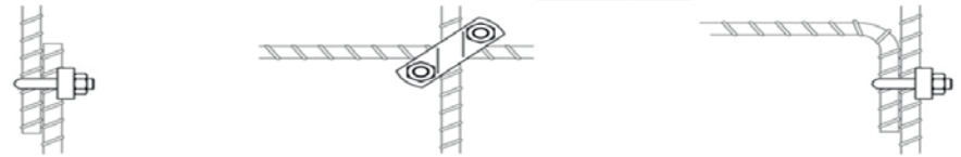
Obrázek E.5c – Svázané spoje (vhodné pro bleskové proudy a účely EMC)
